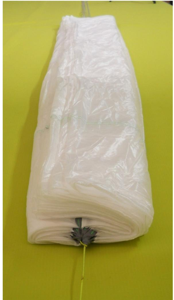
7. Anschließend wird die in Längsrichtung S-förmig gefaltete Kappe nun wie in den nachstehenden Zeichnungen zusammengefoldet
