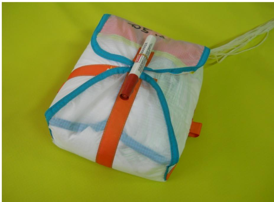
9. Schliesslich kommen wir zum Verpacken der Leinen. Wir packen sie Manuel oder mit Hilfe eines Spezialwerkzeuges. Ist auf jeden Fall wichtig, dass die Breite der Leinenbündel dem des Leinenfaches am Innencontainer entsprechen.(ca. 20 cm )
