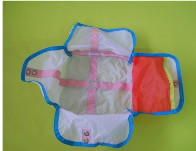
8. Legen Sie nun das vorschriftsmäßig zusammengefaltete Kappen-Paket, kopfüber in den Innencontainer, sodass die Leinen über das Leinenfach verlaufen und schließe die einzelnen Innencontainerblätter ausser das Leinenfachblatt mit einem genormten Gummiring durch die Litzen
