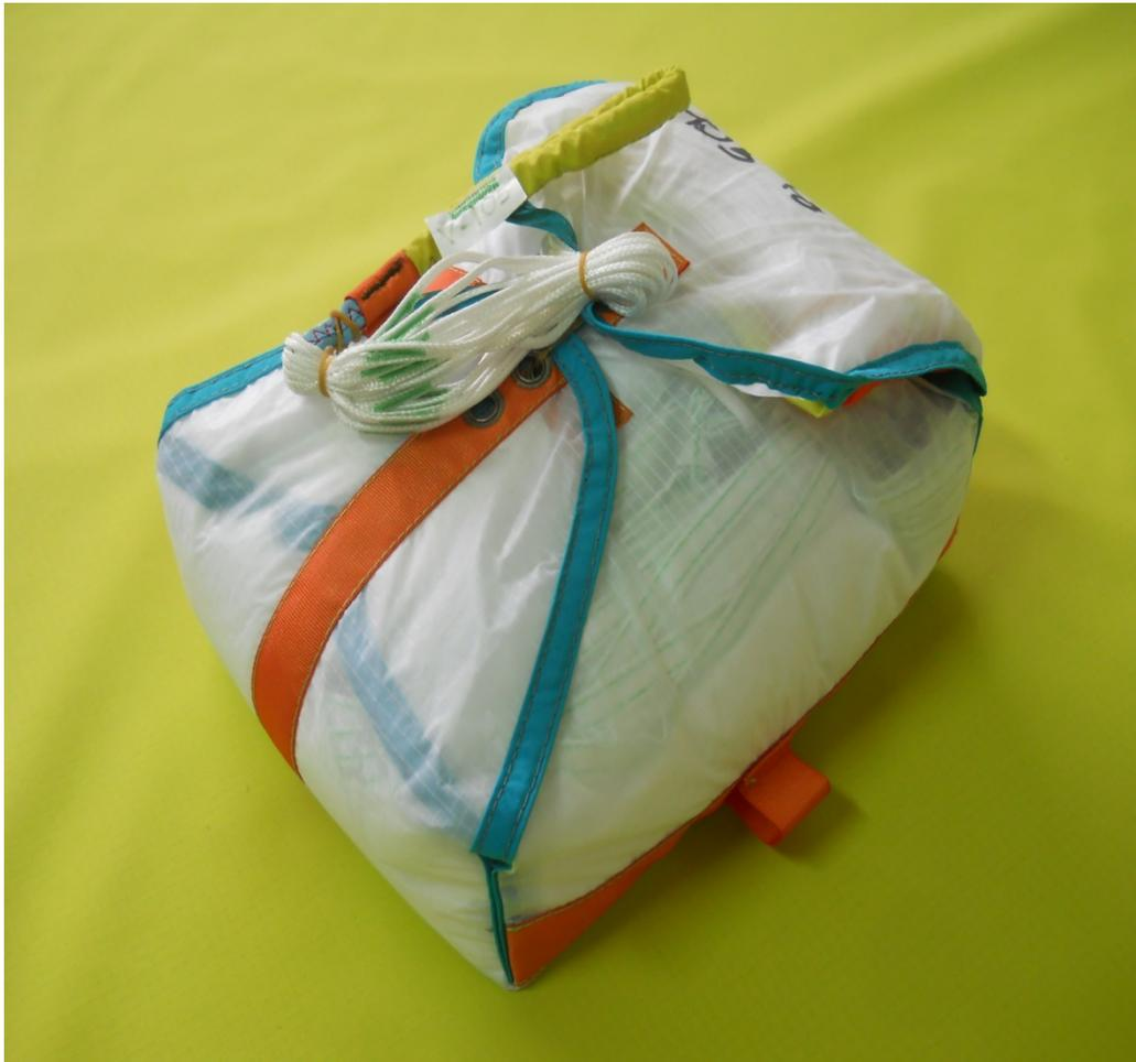
Nun haben sie den Rettungsschirm korrekt in den Innencontainer gepackt. Wir drehen nun das Packet um. Auf der Rückseite befinden sich 4 Schlaufen zum befestigen eines Rettungsgerätegriffes welcher zum Gurtzeuge oder Aussencontainer gehört.
