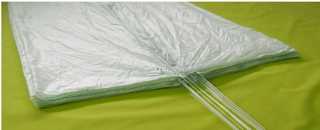
4. Nachdem sie die Bahnen geordnet haben, starten sie mit den Fangleinen. Beginnen sie von der Verbindungsleine ( Tragegurt) und ordnen sie bis zum Scheitel.
