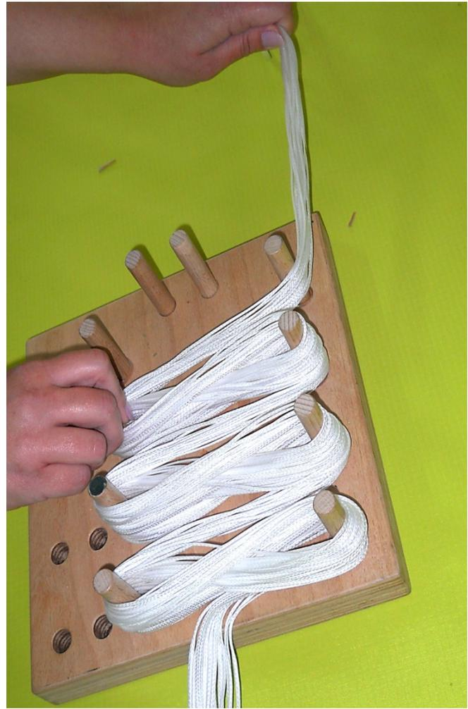
10. Falte nun die Leinen, wie auf der Abb. ersichtlich in 20 cm breiten 8er Schlaufen und fixiere jeden Achter aussen mit einem geeigneten Gummiring. nun verstau sie gem. Abb. im Leinenfach
