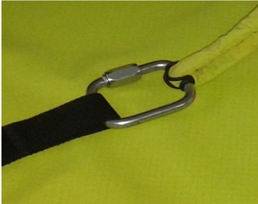
V-Leine deines Gurtzeuges auf eine reibungsfreie Verbindung. Wir empfehlen einen geprüften Schekel mit einer Bruchlast von 3500 daN
