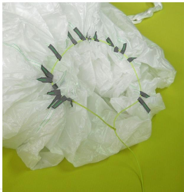
2. Man ergreift Bahn 1 und zählt die Hälfte der Bahnen ( 9 ) ab. Die V-Serie verfügt über insgesamt 18 Bahnen.
